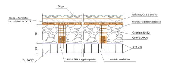
**COLLEGAMENTI LEGNO-LEGNO e COLLEGAMENTI LEGNO - C.A. DA REALIZZARE CON FERRAMENTA STANDARD TIPO SOLTECH-ROTHBLAASS**
