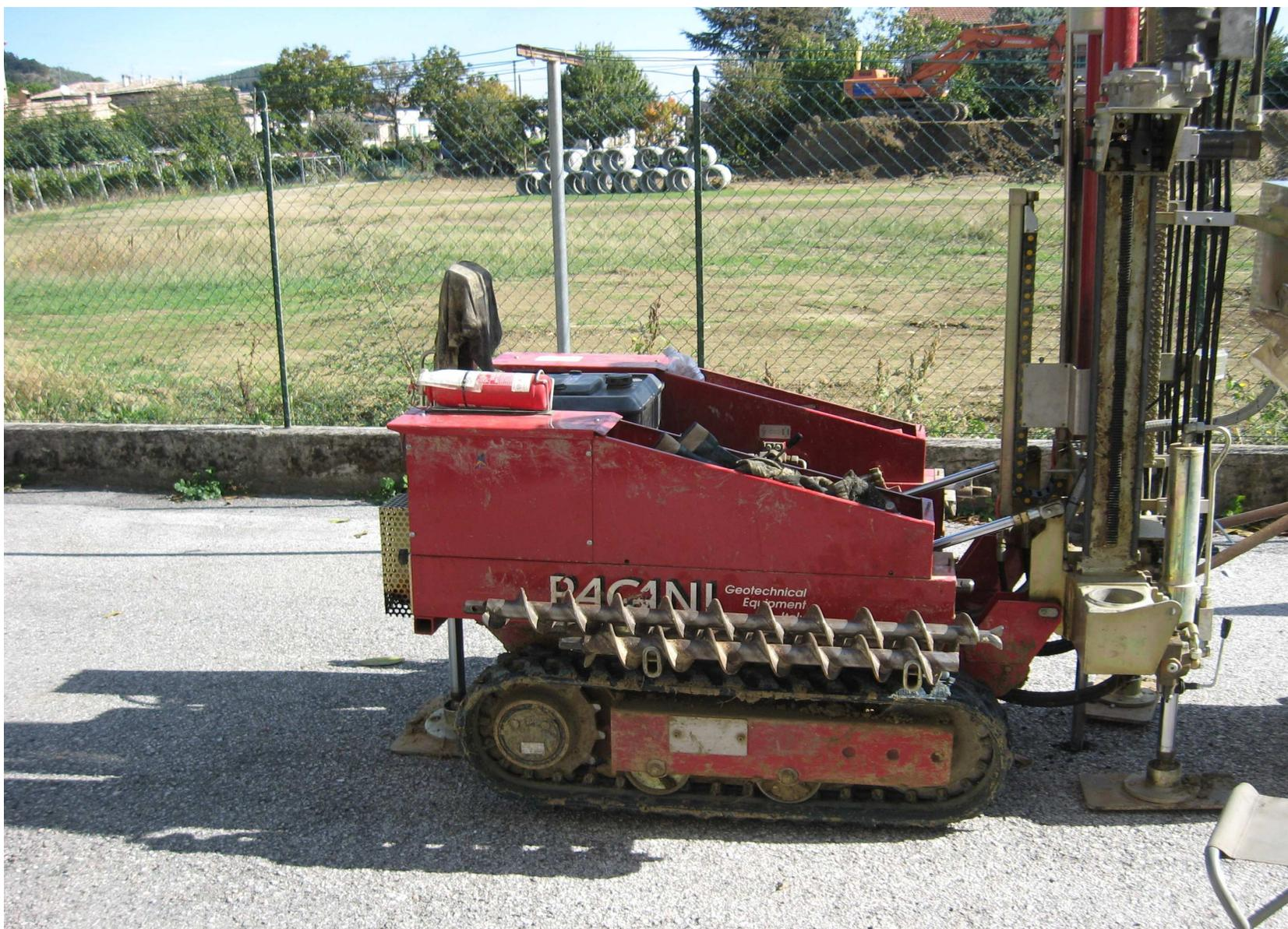
Apparecchiatura utilizzata per le penetrometrie dinamiche
